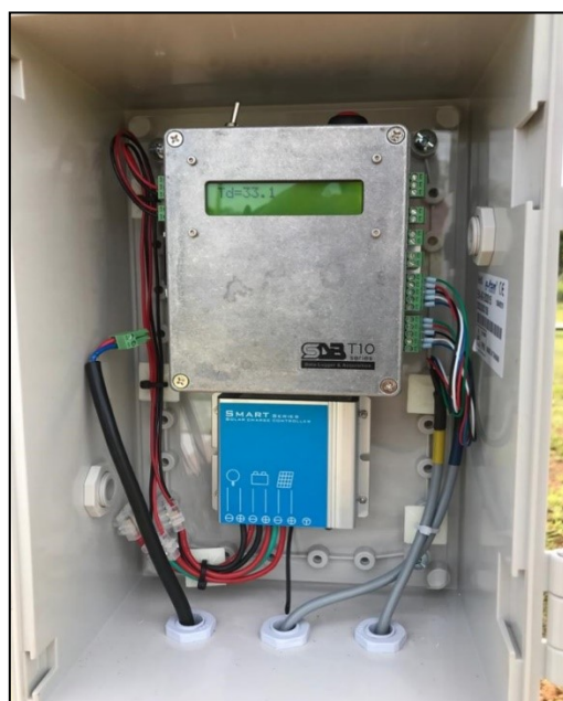
Paparan data logger yang disambung dengan sensor PT-100 menunjukkan data suhu secara nyata View of data logger connected with PT-100 sensor and displays real-time temperature
