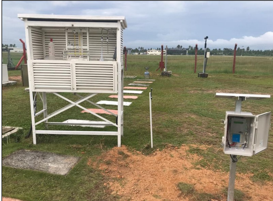
Kedudukan solar panel dan data logger yang disambung dengan PT-100 dalam Adang Stevenson The position of solar panel and data logger which are connected with PT-100 in Stevenson Screen
